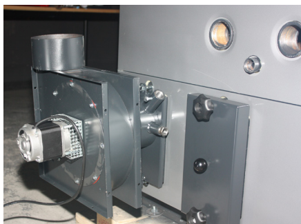
Savukaasuimuri vaihtoehtoinen asennuspaikka kattilan sivulla. Irrota konvektio-osan tuhkaluukku ja asenna savukaasuimuri tilalle.
