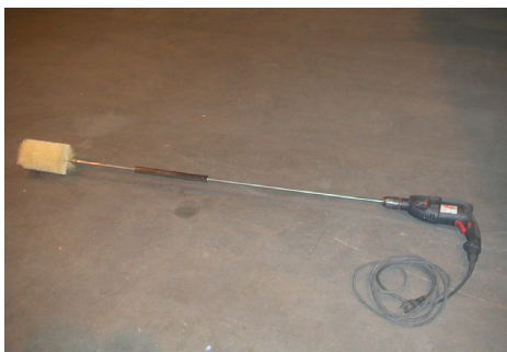
2. Kiinnitä pyörivä harja varteen sekä nämä porakoneeseen.
