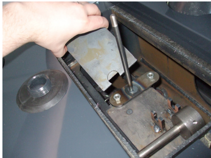
4. Nosta nostotankoa ylöspäin ja nosta konvektiokanavan kansi pois.
