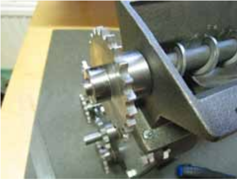
24. Asenna ketjupyörä annosteluruuvien akselille, älä kiristä kiinnitysruuvia vielä...
