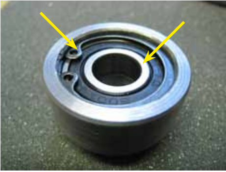
18. Jos laakeria ei ole esiasennettu niin asenna laakeri laakeripesään ja kiinnitä laakerisokka.
