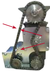
27. Asenna ketju paikoilleen. Kiristä ketju moottorin avulla. Pyöritä polttiruuvia tarvittaessa niin että ketjussa oleva löysyys poistuu. Ketjun vapaaliike saa olla korkeintaan 10 mm moottorin ja annosteluruuvien akselien välillä. Kiinnitä moottorin kiinnitysruuvit. Asenna polttimen kaapelointi päinvastaisessa järjestyksessä.
