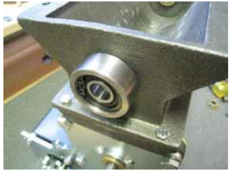
19. Asenna laakeripesä paikoilleen. Käytä laakerilukitetta! Esim. Wurth tai Locktite
