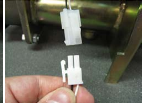
2. Irroita leikinvalvojan liittimet toisistaan painamalla lukitusta ja vetämällä irti toisistaan.
